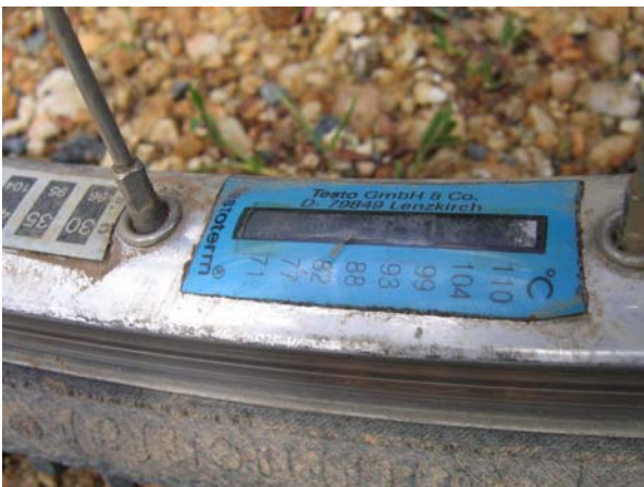
Messstreifen zwischen 104 und 110 Grad, nach dem 3. Test
