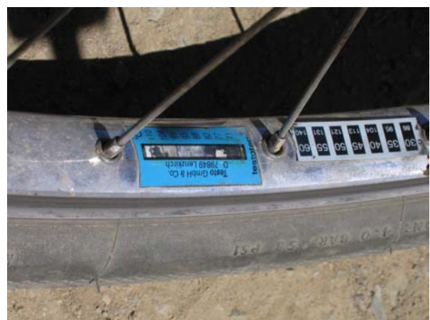
Nicht mehr so brandneu: Wasserflecken und beginnende Ablösung.
