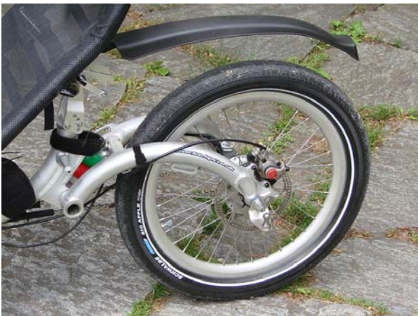
Bild 4: Die mit Elastomerblöcken gefederte, durchgestylte Hinterradschwinge des ICE Trice T
