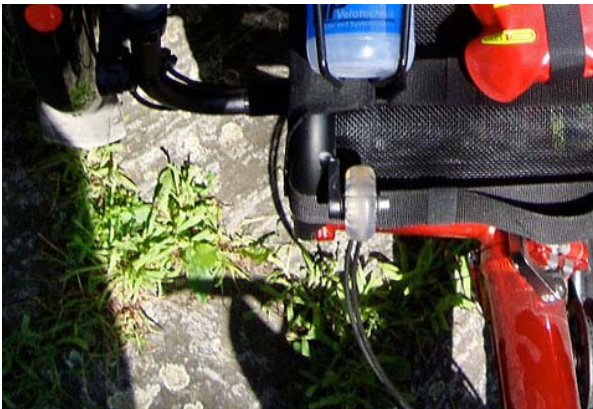
Bild 6: Die werkseitig montierten mickrigen Transportröllchen am HP Gekko fx
