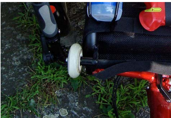
Bild 7: Meine Lösung mit den Inline-Skater-Rollen
