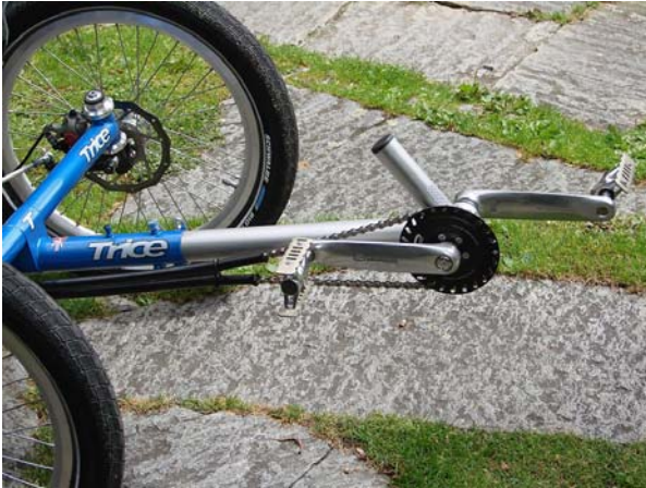
Bild 3: Die Schlumpf HighSpeedDrive-Tretlagerschaltung am ICE Trice T
