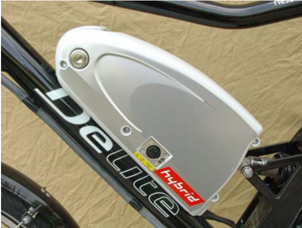
Bild 4: Abschließbarer, abnehmbarer Akku
