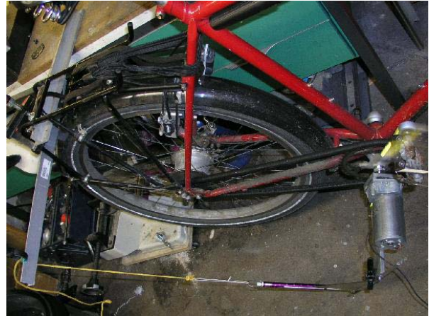
Bild 7: Messaufbau für die Antriebsleistung
