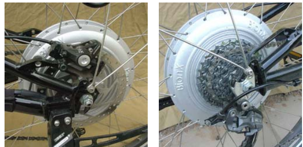
Bild 2+3: BionX-Antriebsnabe mit 8-fach-Schraubkranz und Scheibenbremse
