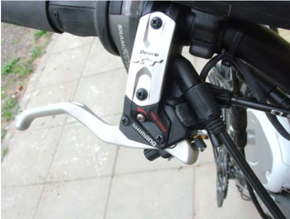
Bild 6: Steuertaster am Griff der Hinterradbremse; schaltet beim Bremsen den Motor temporär auf Generatorbetrieb um (dieser ist aber auch manuell einstellbar).
