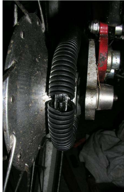
Bild 2: Montage CR (entgegen der Montageanleitung nicht gestaucht), Nabe ungeputzt nach 473 km CG
