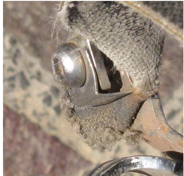
Bild 4: Die vordere Befestigung der Powergrips – Detail der Riemenklemmung
