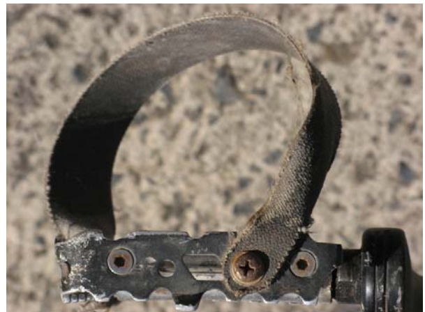
Bild 2: Die hintere Befestigung der Powergrips – Reflektoren müssen fürs Erste abmontiert werden
