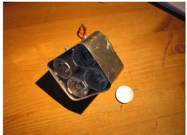
„Schielender“ 4-fach-Cree-Nahscheinwerfer, der oben den Vergleichstest im Garten bestritten hat (70*60 mm, 150g), bis zu 400 lm . 3 Carclo Extra Narrow 4 Grad/26 mm Optiken sowie eine Carclo Elliptical Narrow 4*25 Grad horizontal.
