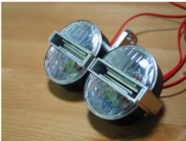
4-fach aus zwei abgedrehten B&M Lumotec von Rainer Mai (Danke Rainer!), 90*50 mm, 120 g, bis zu 400 lm. Streut leider zu weit für die Straße, da die Leuchfläche der LEDs zu groß im Vergleich zum kleinen Reflektor (Ø 42mm) ist, deshalb jetzt am Liege-MTB montiert.
