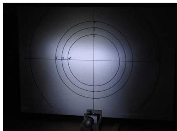
Der E6-„Touchdown“ an 100 mA/6,4 Volt/ 0,64 Watt mit Seoul P4-LEDs
