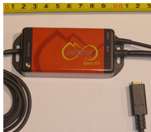
Bild 1: Velotor Sport E2 – kann parallel USB-Verbraucher und Dynamolicht versorgen
