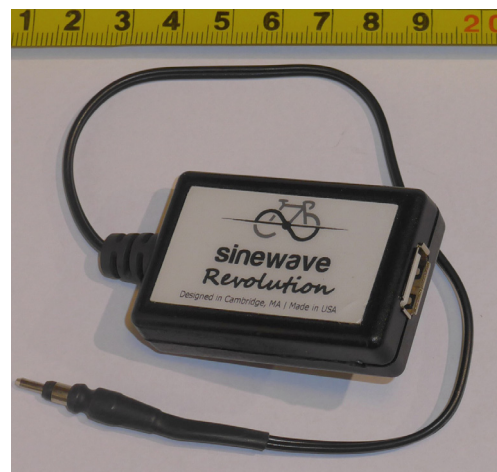
Bild 6: Sinewave Cycles Revolution – kompakt und bewährt. Der SON Koax-Stecker wurde vom Autor nachgerüstet.
