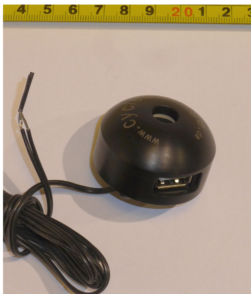
Bild 7: Cycle2Charge V3 plus – unscheinbares Kunststoffgehäuse, aber gute Ladeleistung, insbesondere bei zügiger Fahrt
