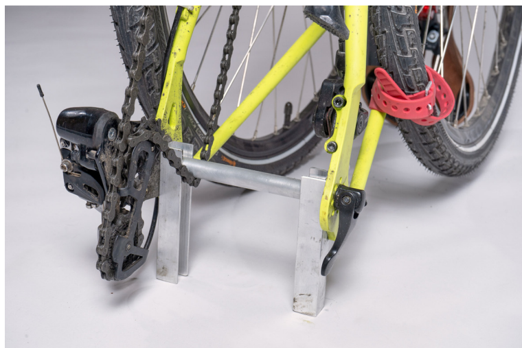
Bild 3: Selbst gebauter Rinko-Ständer für Steckachse
