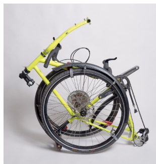
Bild 9: Gabel drin, Lenker ab – das Paket wird etwas handlicher
