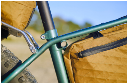
Bild 16: Die zentrale Idee verbirgt sich im Winkel zwischen Oberrohr und Sattelrohr. Durch diese Hülse steckt man eine Achse, auf der sich die Laufräder montieren lassen. Von: M. Gloux
