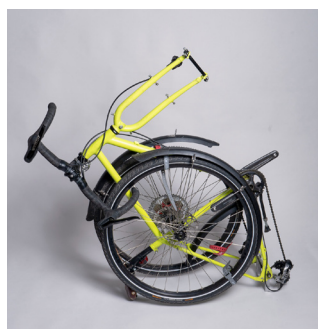
Bild 7: »Easy Rinko« – Gabel und Lenker bleiben montiert. Diese Lösung erspart viele Probleme und ist auch bei innen verlegten Zügen und Scheibenbremsen möglich.
