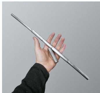
Bild 17: Die Achse für die Laufräder Von: M. Gloux
