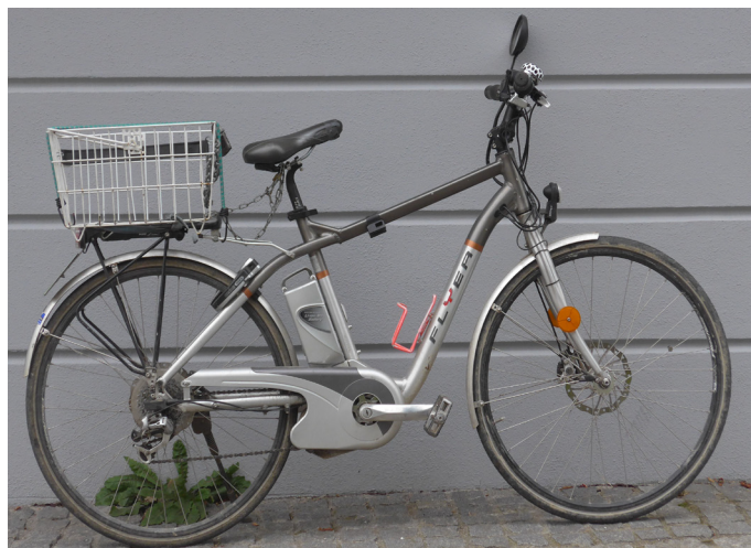
Bild 1: Pedelec mit Scheibenbremse: real 32 kg
