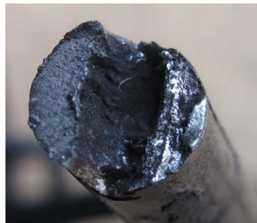
Bilder 18 und 19: Gestell-Bruchbilder. Die glitzernde Fläche rechts ist durch Reibung des geschient weiterbelasteten Drahts entstanden.
