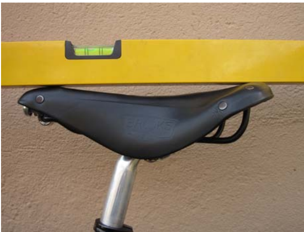
Bild 10: Normaler Durchhang meines etwa 10.000 km alten, nie gespannten Reiseradsattels (B17 N). Mehr wird das nicht – wenn ich nicht den Fehler mache, zu spannen ...
