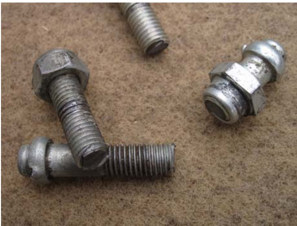
Bild 13: Sammlung gebrochener Spannschrauben
