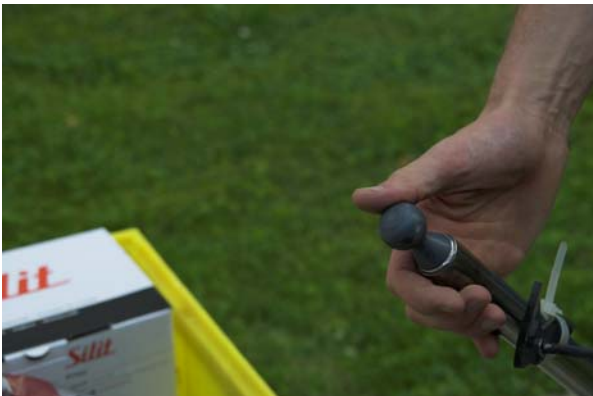
Bild 4: Die Kugel rastet an der Chariot-Kupplung ein und dient gleichzeitig als Handgriff.
