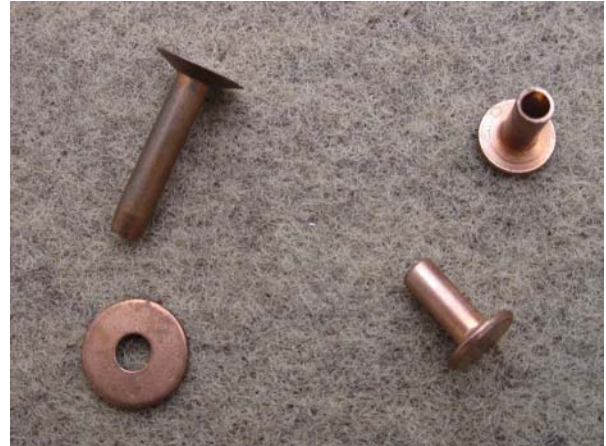
Bild 20: Links massiver Kupferniet aus dem Ledergeschäft mit (notwendiger) Stützscheibe, rechts zwei verkupferte Stahl-Hohlните von Brooks
