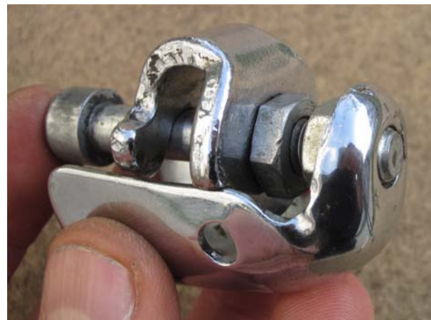
Bild 16: Fertig „montierte“ M8-Umstrickschraube
