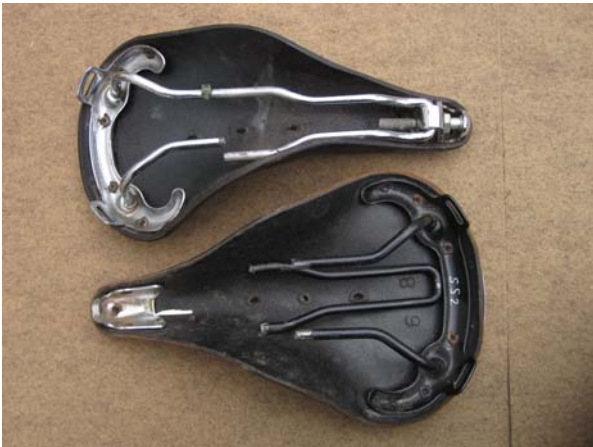
Bild 17: Zwei B17-Gestelle, die nach dem Bruch „geschient“ und noch einige tausend Kilometer gefahren wurden
