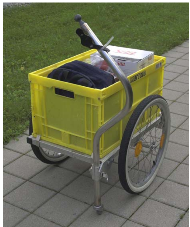
Bild 3: Der Anhänger als Handwagen. An der Rahmenecke ist die Deichsel schwenkbar befestigt.
