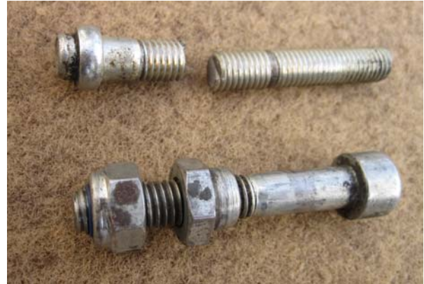
Bild 15: Oben ein gebrochener zölliger Original-Gewindebolzen, darunter die metrische Reparaturlösung mit umgeschnittener Brooks-Mutter
